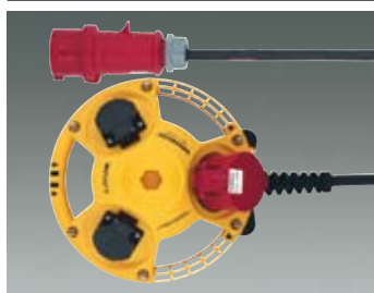
1 prise CEE 16A, 5P, 400V 2 prises SCHUKO® 16A, 230V câble d'alimentation de 3 m H07RN-F5G2,5 avec fiche CEE 16A, 5P, 400V Réf. 94356
