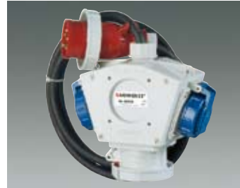
1 prise CEE 16A, 5p, 400V 2 prises SCHUKO® 16A, 230V câble d'alimentation de 2 m H07RN-F5G2,5 avec fiche CEE 16A, 5p, 400V ▲▲ IP 67 Réf. 92908
