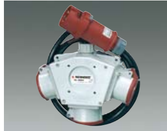
3 prises CEE 16A, 5P, 400V câble d'alimentation de 2 m H07RN-F5G2,5 avec fiche CEE 16A, 5p, 400V ▲ IP 44 Réf. 92914
