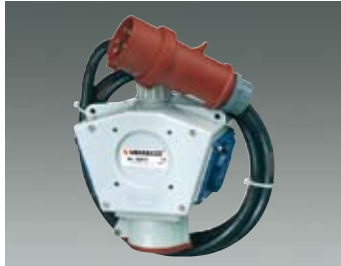
1 prise CEE 16A, 5p, 400V 2 prises SCHUKO® 16A, 230V câble d'alimentation de 2 m H07RN-F5G2,5 avec fiche CEE 16A, 5P, 400V ▲ IP 44 Réf. 92913
