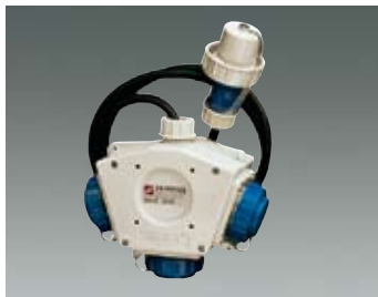
Prolongateur triple SCHUKO® 16A, 230V avec couvercle à baïonnette accroché par ruban câble d'alimentation d'1,5 m H07RN-F5G2,5 avec fiche SCHUKO® 16A, 230V ▲▲ IP 68, étanche à l'eau sous pression Réf. 92386
