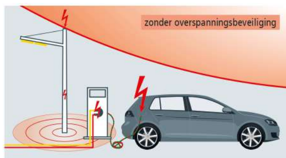
Afbeelding 1 Inkoppeling van bliksem en overspanningen tijdens het laadproces
