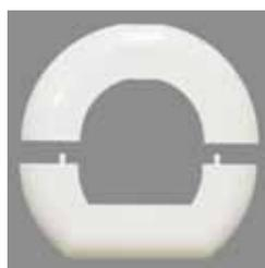
L'évidement pour le passage des câbles dans le faux plafond est achevé par une plaque de finition en matière synthétique de couleur blanche. Elle se compose de deux parties en vue d'un montage simple après l'installation de la colonne. Les deux parties s'encliquettent l'une dans l'autre, ce qui rend le vissage ou collage superflu.
