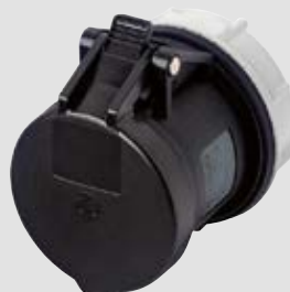
Inbouwcontactdoos RAPIDO® TwinCONTACT, schroefloos met insteekklems, geschikt voor doorlussen, voor boorgat 70 mm Ø, centrale bevestiging
