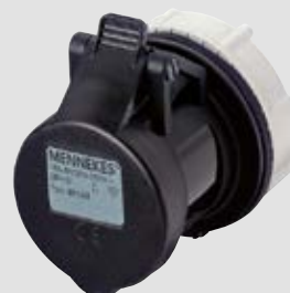
Inbouwcontactdoos RAPIDO® TwinCONTACT, schroefloos met insteekklems, geschikt voor doorlussen, voor boorgat 61 mm Ø, centrale bevestiging
