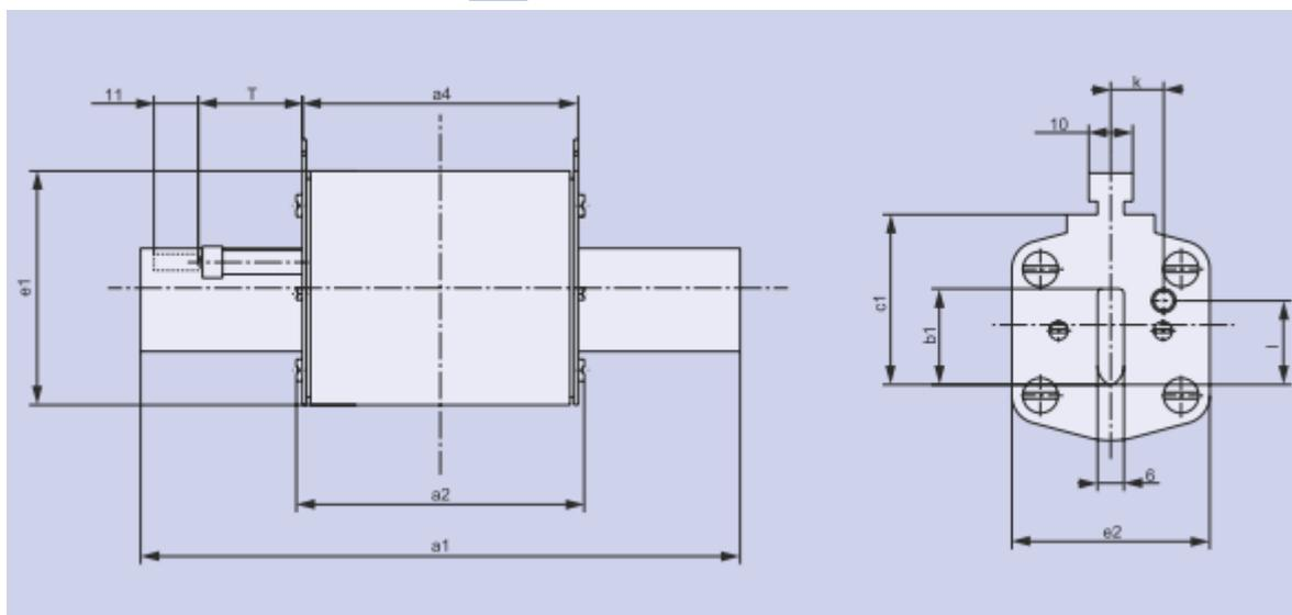
**Fusibles NH contacts à couteaux pour la protection des modules photovoltaïques dans les systèmes PV gPV**
