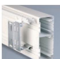
Le système de gaines murales DUCTEL peut être fixé directement contre la paroi ou par l'intermédiaire de supports muraux. Des parois inégales peuvent être compensées par des pièces ajustables. L'ouverture derrière les gaines murales peut être couverte d'une plaque de couverture.
