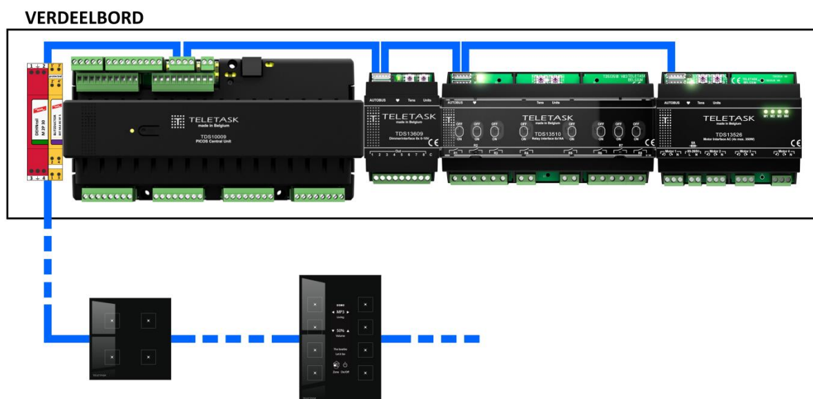
Figuur 5: positie van de beveiligingen bij een Picos centrale
