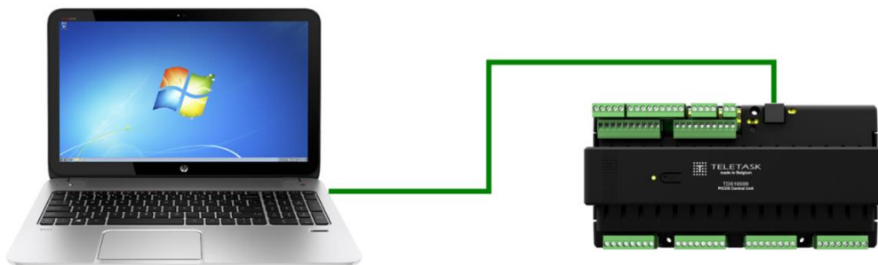
Figuur 13 : Rechtstreekse verbinding tussen PC en centrale
