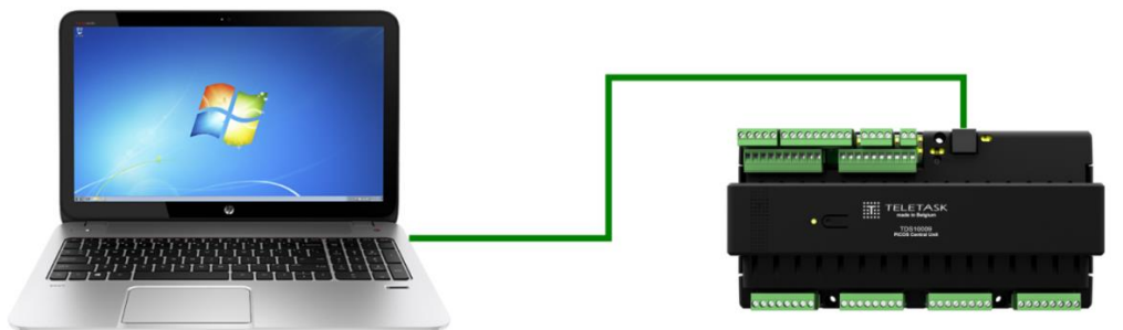
Figuur 13 : Rechtstreekse verbinding tussen PC en centrale
