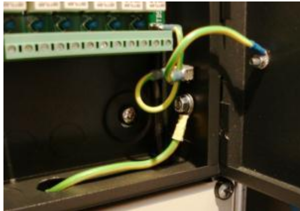
Figuur 2 : Details aansluiting aardingsklem MICROS+
