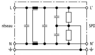
Schéma de principe du circuit NF 10
