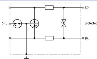
Schéma de principe du circuit DPI MD 24 M 25
