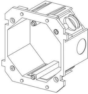
Une boîte d'appareillage simple en matière synthétique en couleur bleue pour un mécanisme standard avec anneau porteur. Si on utilise plusieurs boîtes, le centre d'axe des mécanismes est de 71 mm.
