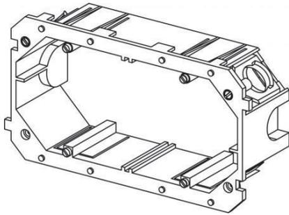
Boîte d'appareillage double en matière synthétique, couleur bleue pour un mécanisme avec anneau porteur. Le centre d'axe des mécanismes est de 71 mm.
