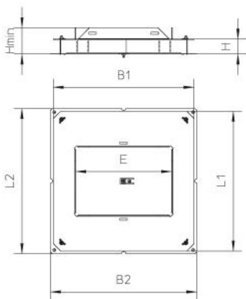
La boîte de construction vide est fabriquée en tôle d'acier galvanisée Sendzimir et est pourvue d'une borne de mise à la terre UBDHB Z.
