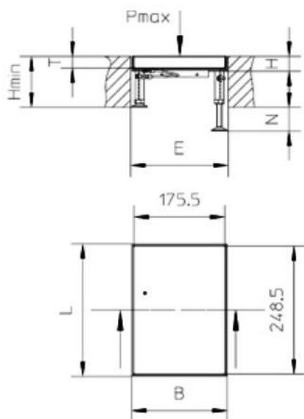
La cassette de l'unité de nivellement rectangulaire et le couvercle aveugle sont fabriqués en acier inoxydable.
