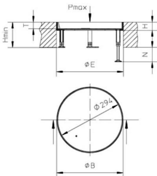
La cassette de l'unité de nivellement ronde et le couvercle aveugle sont fabriqués en acier inoxydable.
