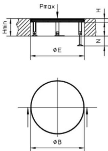
La cassette de l'unité de nivellement ronde et le couvercle aveugle sont fabriqués en acier inoxydable.
