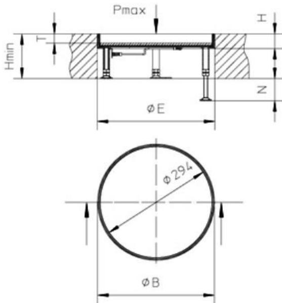
La cassette de l'unité de nivellement ronde et le couvercle aveugle sont fabriqués en acier inoxydable.
