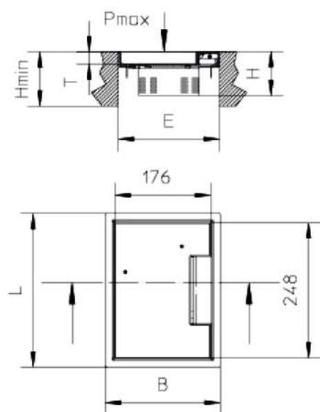
Le rebord, le couvercle autofermant avec sortie latérale et le levier autofermant sont fabriqués en acier inoxydable.
