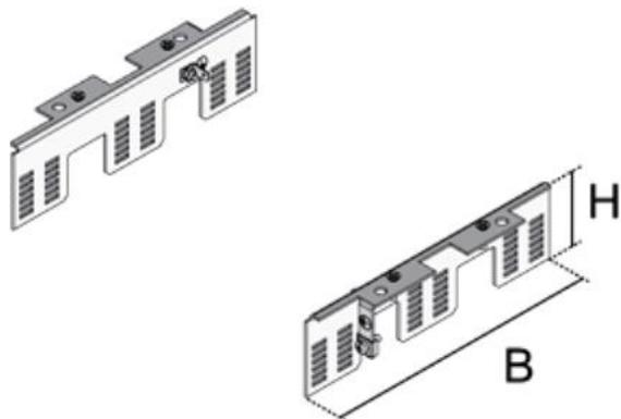
Le set de montage avec grilles est fabriqué en tôle d'acier galvanisée Sendzimir.
