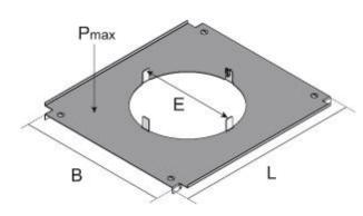
Le couvercle de montage est fabriqué en tôle d'acier galvanisée Sendzimir.
