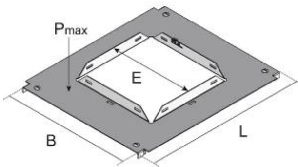
Le couvercle de montage est fabriqué en tôle d'acier galvanisée Sendzimir.
