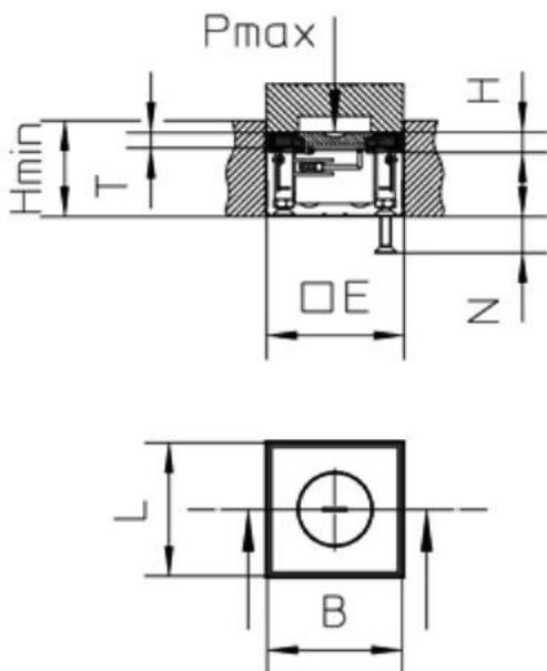
La boîte de construction avec opercules défonçables M25 est fabriquée en tôle d'acier. Le corps de coffrage est fabriqué en Styropor. La cassette de l'unité de nivellement et le couvercle avec sortie centrale sont fabriqués en acier inoxydable.
