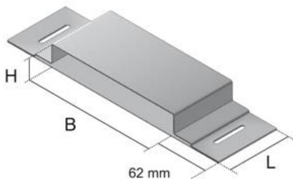
Le manchon de fixation est fabriqué en tôle d'acier galvanisée Sendzimir. Le manchon est utilisé pour fixer les extrémités des gaines de sol et les pièces de montée au plancher dans des endroits avec des joints de dilatation. Le manchon est pourvu de fentes afin de pouvoir fixer à l'aide de chevilles à clou UN 5/38.
