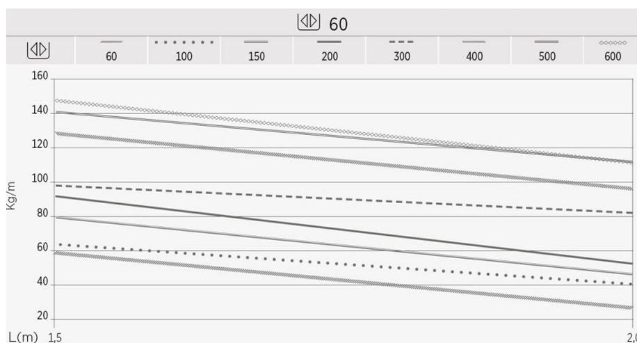
Les valeurs sont obtenues lors des essais en conformité avec la norme NBN EN 61537, avec un coefficient de sécurité 1,7, sans jamais atteindre le point de rupture.
