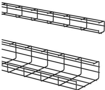
Le treillis de plafond Rejitech G+ est fabriqué en fils d'acier et est pourvu d'un revêtement minéral organique noir Black C8 selon NBN EN ISO 2081. Ce revêtement est résistant à la corrosion classe 8 conformément à la NBN EN 61537.
