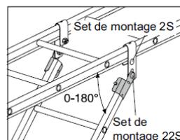
Utilisez une clame 12 et une partie d'un accouplement 22 pour une dérivation inclinée sous une autre échelle à câbles. Permet de réaliser des dérivations entre 0° et 180°.
