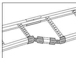
Alternative au passage d'échelles KHZSP, KHZPS, KHZSPZ, KHZ et KHZP: utilisez un accouplement 21 et deux accouplements 22.
