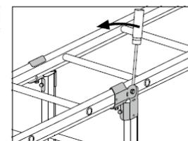
Utilisez deux accouplements 22 pour une dérivation verticale sous une autre échelle à câbles. Attention! Le boulon d'accouplement 22 doit être tourné de telle façon jusqu'à ce que la tête repose sur le longeron. Incliner l'accouplement avec un tournevis comme illustré ci-dessus.
