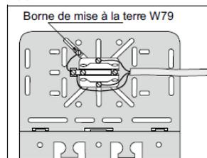
Les bornes de terre sont appliquées lorsque, au montage de certains appareils, la mise à la terre de protection est requise suivants les prescriptions de courant fort en vigueur. Grâce aux ouvertures dans la plaquette de montage, la borne de terre peut être déplacée jusque sous l'enveloppe de l'appareil.
