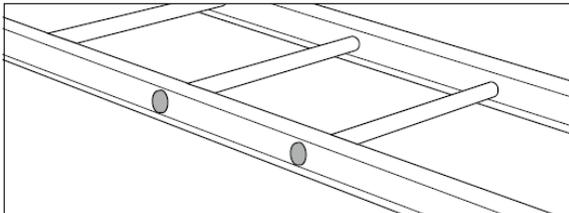
Les extrémités des échelons de KHZ et KHZV sont protégées contre les effets de l'humidité, la poussière et la pollution atmosphérique par des bouchons de protection 27.
