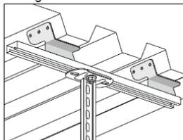
Fixez un rail de montage 40 entre deux étriers de plafond 5TPA pour monter un pendent à la distance appropriée.
