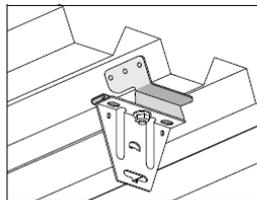
Un étrier de plafond 5 ou un étrier de plafond W31 peut être fixé à l'aide du boulon et écrou compris.
