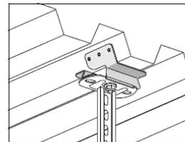
Un pendent 2 ou 2F peut être fixé à l'aide du boulon et écrou compris.
