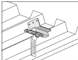
Une éclisse d'assemblage W21 ou un étrier pour tige filetée W73 peut être fixée à l'étrier de plafond 5TPA à l'aide du boulon et écrou compris.
