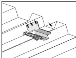
L'étrier de plafond 5TPA est fixé contre une construction trapézoïdale à l'aide de rivets tubulaires ou de boulons. L'étrier est réglable de 35 à 95 mm.
