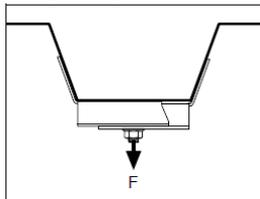
L'étrier de plafond 5TPA peut supporter une charge de 150 kg sans déformation. Il faut aussi tenir compte des caractéristiques de charge de la tôle d'acier et des dispositifs de fixation. Suivez les recommandations du fournisseur.
