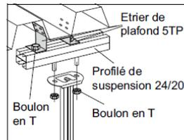
On peut, en alternative, utiliser le profilé de suspension 24/20. Dans ce cas, quatre boulons en T sont requis.
