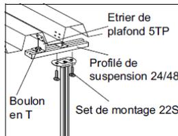
Sur les plafonds à profilés trapézoïdaux, les pendants 2, 2F ou 20 sont installés à l'aide de deux étriers de plafond 5TP, un profilé de suspension 24/48, deux boulons en T et deux sets de montage 22S.
