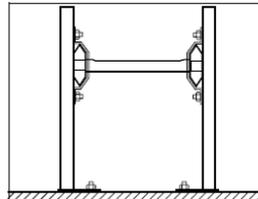
Fixation d'une échelle à câbles sur des pendants. Fixez-la à l'aide de boulons en T dans l'ouverture des profilés.
