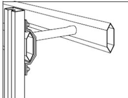
Fixation d'un profilé de suspension sur un longeron. Utilisez des sets de montage 22S.
