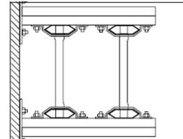
Montage d'échelles à câbles sur des pendants horizontaux, p. ex. dans une fosse. Fixez-les à l'aide de boulons en T dans l'ouverture des profilés.
