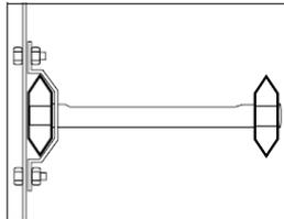
Fixation d'une plaque de montage. Utilisez des sets de montage 22S.
