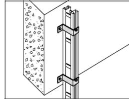
Le profilé de suspension 24/20F peut être fixé à une poutre ou au mur avec des étriers muraux 20F.
