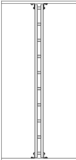
Le profilé de suspension 24/20F peut être calé entre le sol et le plafond à l'aide de 4 équerrres 5L et 4 boulons en T.
