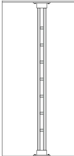
Le profilé de suspension 24/20F peut être installé entre le sol et le plafond à l'aide de deux supports pour profilé 24/20F.
