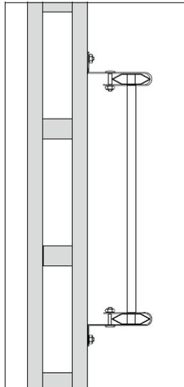
L'échelle à câbles peut être installée verticalement ou horizontalement sur le profilé 24/20F à l'aide d'étriers muraux 11/25 ou 11/75 et de boulons en T.
