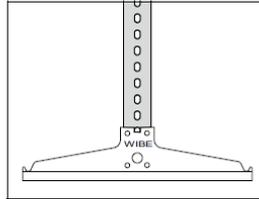
Le support console 3 est fixé à l'aide d'un set de montage 2S.
