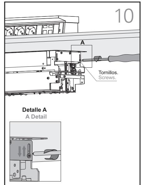
Colocar la protección inferior y atornillar los cuatro tornillos. Una vez colocado todo, conecte la caja a la red eléctrica y las conexiones multimedia. La caja está preparada para ser utilizada.
