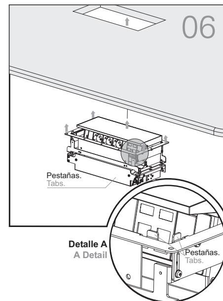
Atornillar las cuatro esquinas de la pestaña de sujeción al tablero, sin apretar totalmente, para poder alinear la caja posteriormente. Una vez alineada colocar el resto de los tornillos.
