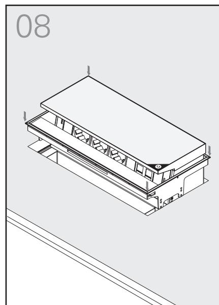
Introducir el marco perimetral por la parte superior hasta que encaje sobre el tablero.
